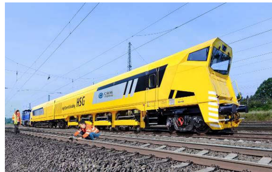
图 4: 钢轨快速打磨车
