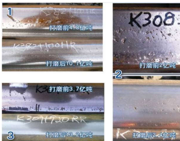
图 3: 钢轨打磨前后状态对比图
